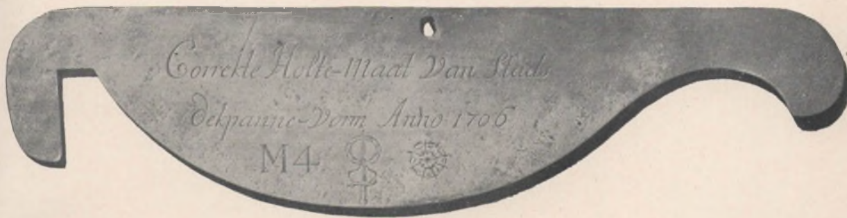
D 9. Rood koperen maat voor dakpannen met opschrift: „Correkte Holle-Maat Van Stad dekpanne-Vorm, Anno 1706”. Daaronder M 4 en het wapen der stad met eene rosel.
